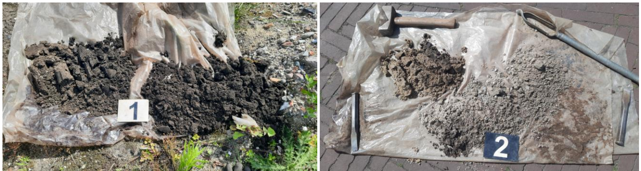
Afbeelding 4: boorprofielen profileringsboringen 1 en 2.
