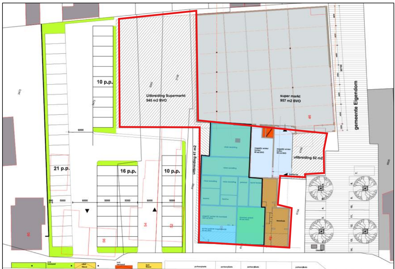
Figuur 1. Huidige situatie met de te slopen bebouwing, aangegeven met het blauwe vlak. Met arcering zijn de beoogde uitbreidingen weergegeven. Het plangebied is aangegeven met het rode kader (Bron: Aangeleverd door de opdrachtgever).
