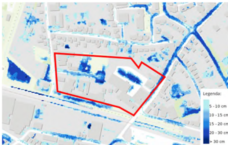
Figuur 11, waterdiepte bij hevige bui | 70 mm / 2 uur (bron: klimaateffectatlas)
