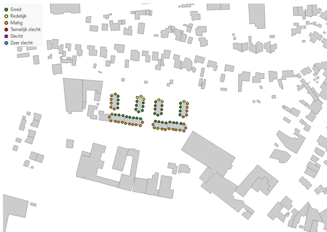
figuur 9: beoordeling gecumuleerd geluid op de gevels fase 1
