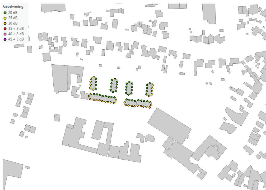
figuur 8: benodigde gevelwering op het plan Groene Heerlijkheid fase 1
