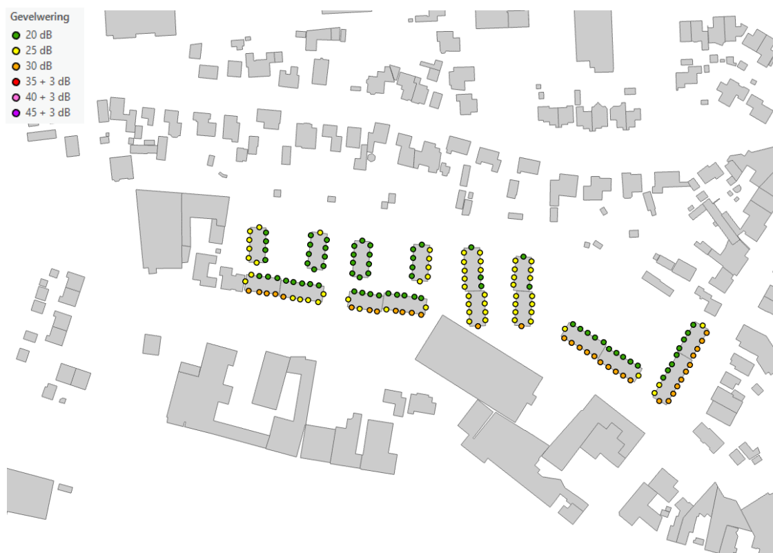
figuur 12: benodigde gevelwering op het plan Groene Heerlijkheid fase 2
