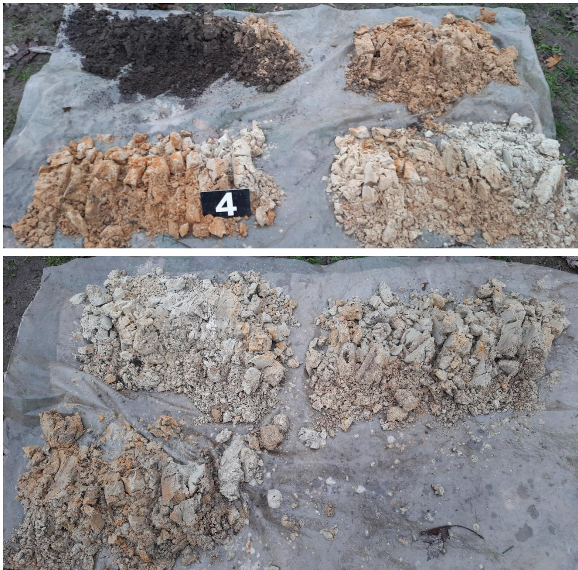
Afbeelding 6: Foto profielboring uitgelegd per meter vanaf maaiveld (linksboven) tot einddiepte (onder).
