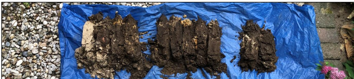
Boring 2: 0-120 cm -Mv, gestaakt op puin. Ook tweemaal gestaakt op puin op een diepte van 70 en 95 cm - Mv.
