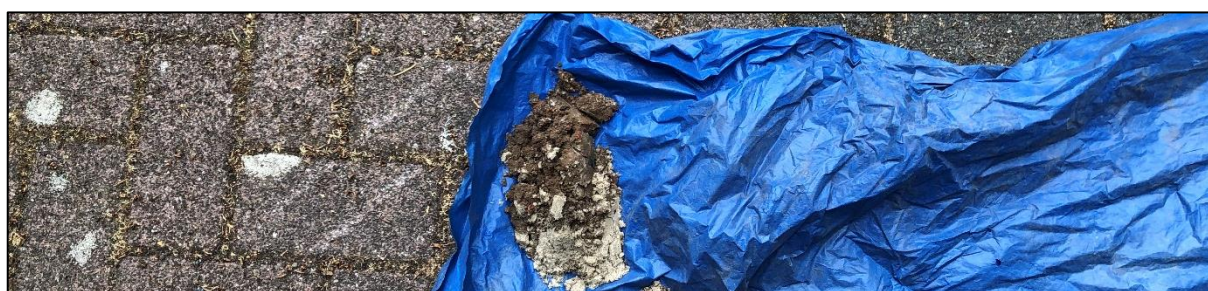
Boring 4: één van de drie pogingen gestaakt in puinlaag. Ook representatief voor boring 5.
