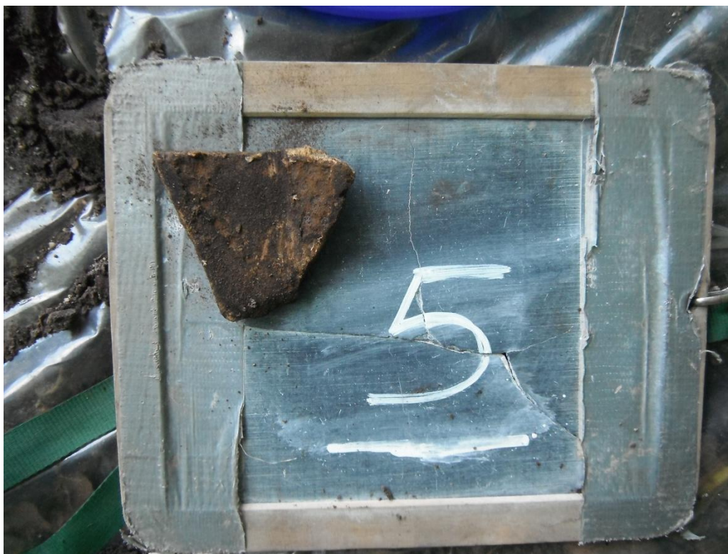
Foto 13. Asbestverdacht materiaal sleuf 05
