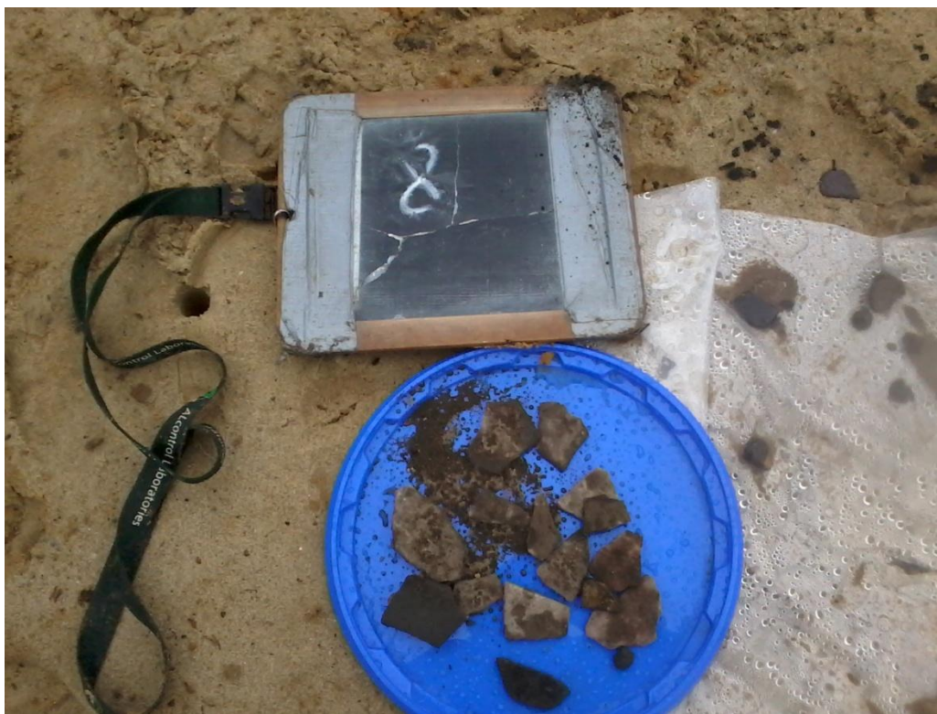
Foto 19. Asbestverdacht materiaal sleuf 08
