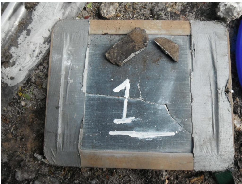
Foto 3. Asbestverdacht materiaal sleuf 01
