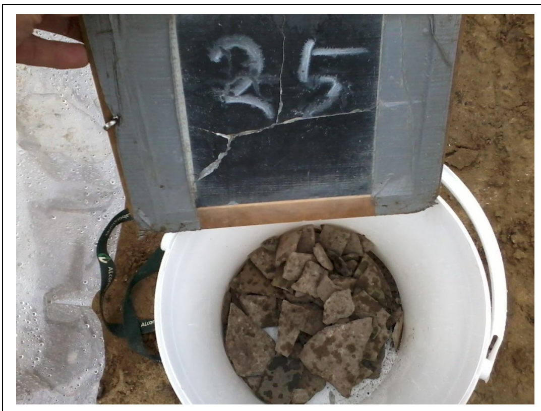
Foto 51. Asbestverdacht materiaal sleuf 25
