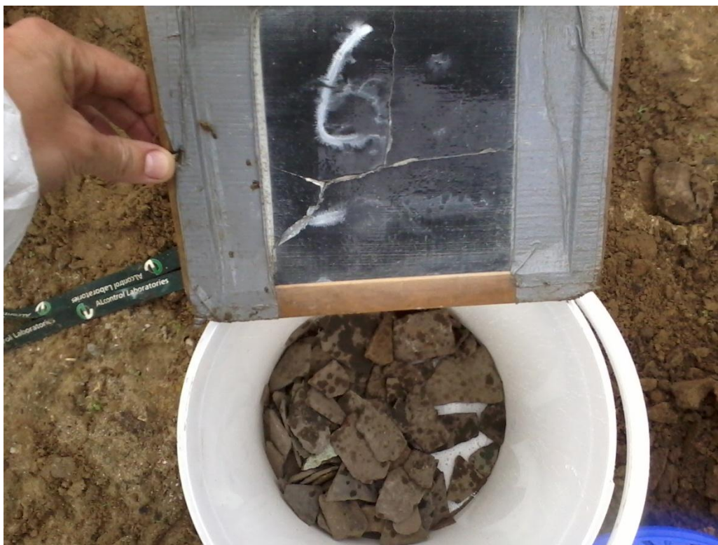
Foto 16. Asbestverdacht materiaal sleuf 06
