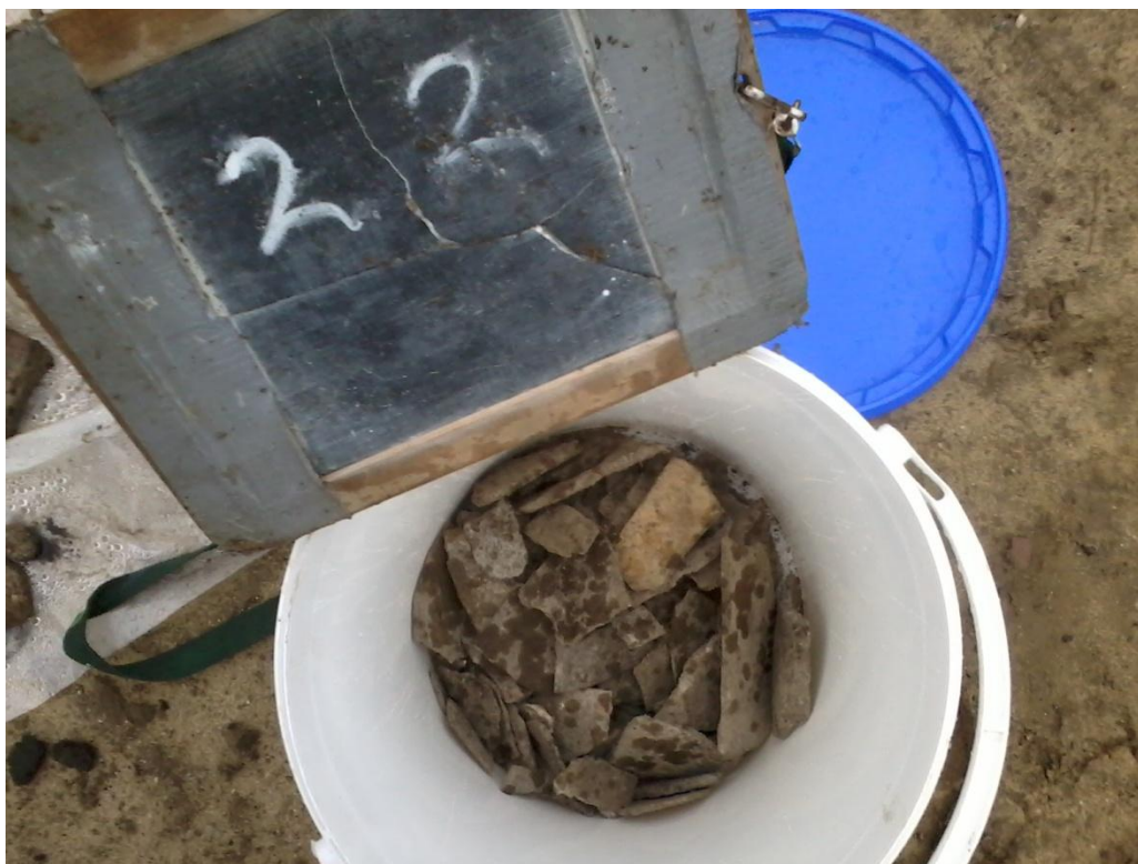
Foto 42. Asbestverdacht materiaal sleuf 22
