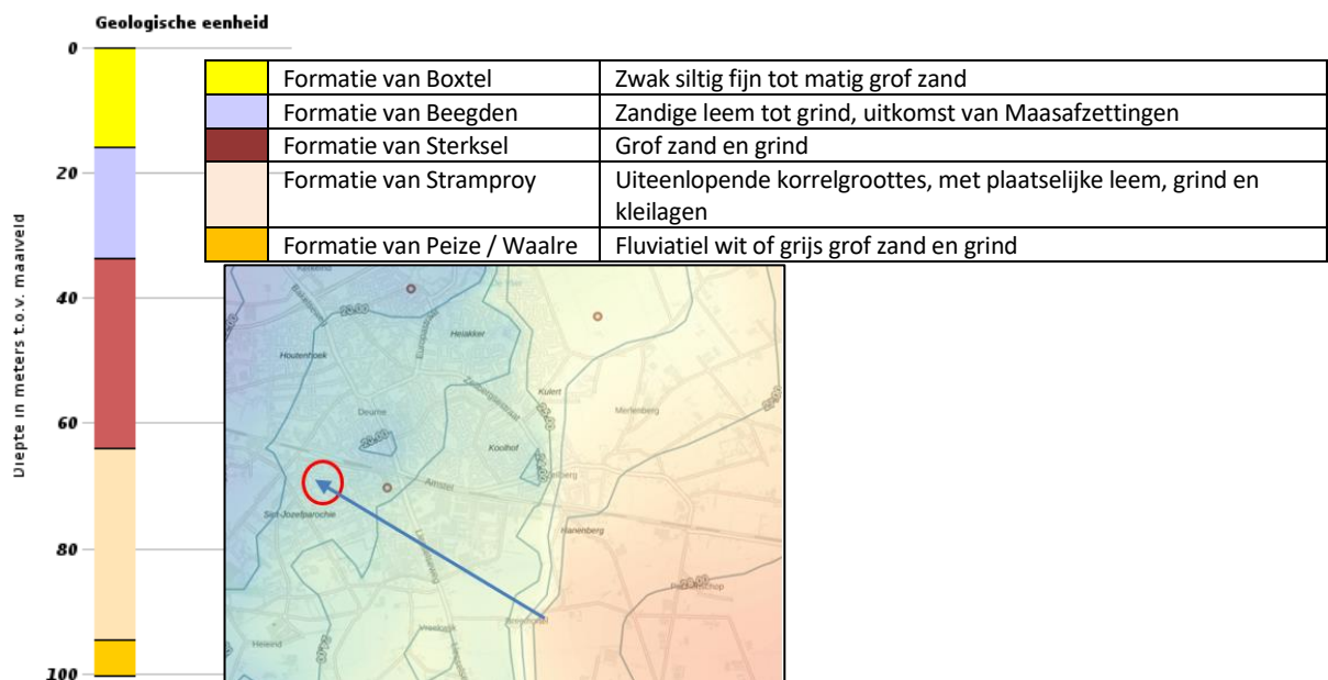
Figuur A: opbouw ondergrond.
