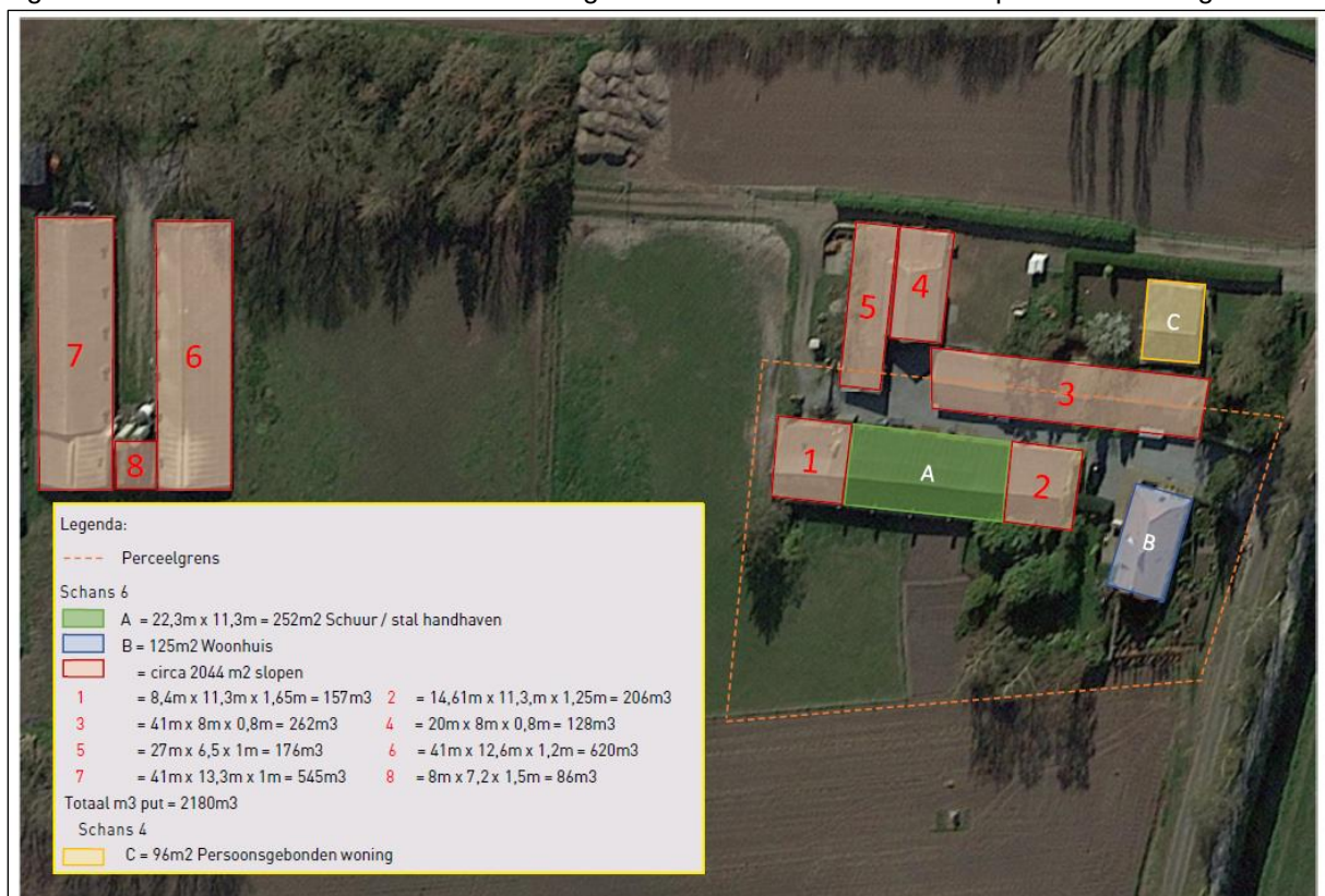
Figuur 6: Overzicht te slopen bebouwing
