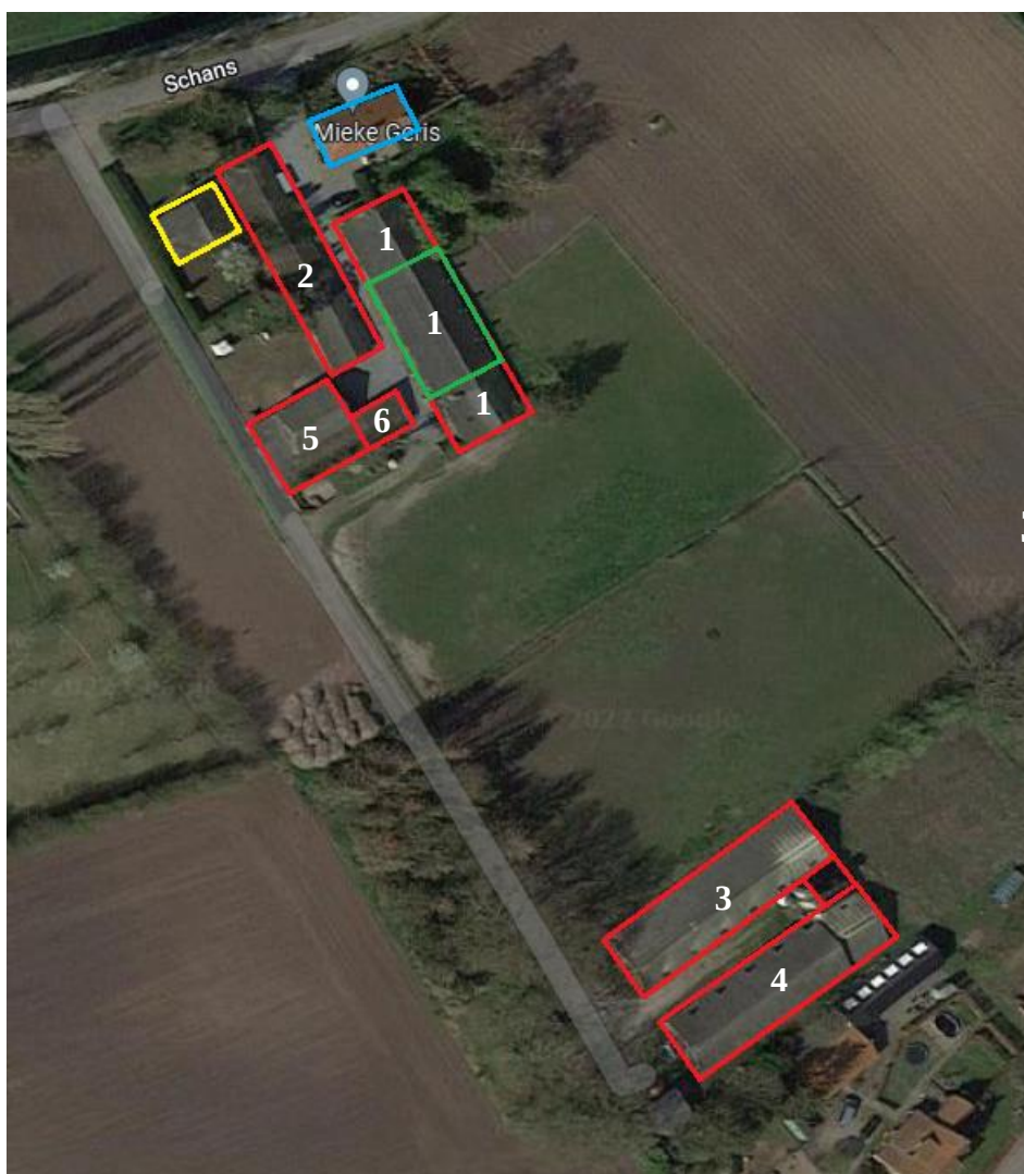
Figuur 4.1. Overzicht van het plangebied met de te slopen genummerde gebouwen (rood gekleurd), het te behouden deel van een stal 1 (groen gekleurd) en het te verbouwen woonhuis (blauw gekleurd). De persoonsgebonden woning (geel gekleurd) blijft in de huidige staat behouden.
