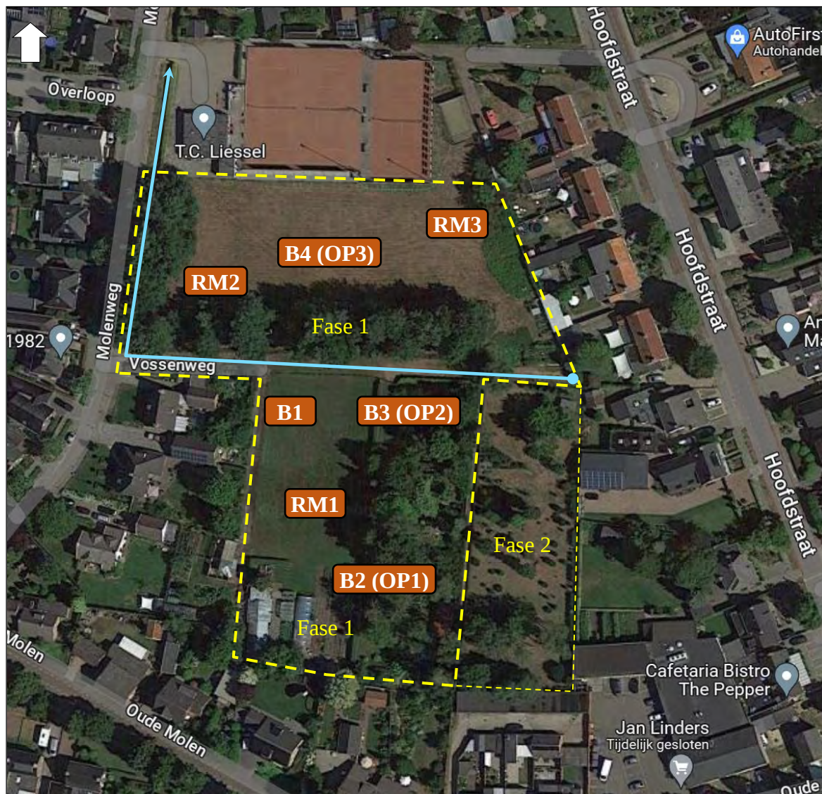
Figuur 2: Infiltratieonderzoek fase 1. Situering van de 3 dubbele-ring-infiltratiemetingen (RM1 t/m RM3), de 3 omgekeerde putproeven (OP1 t/m OP3) en de 4 boringen (B1 t/m B4) om de bodemopbouw en het grondwaterpeil vast te leggen en de watergang (blauwe lijn) die beide deelterreinen doorsnijdt. Ter plaatse van fase 2 zijn na overleg met de gemeente Deurne geen metingen uitgevoerd.
