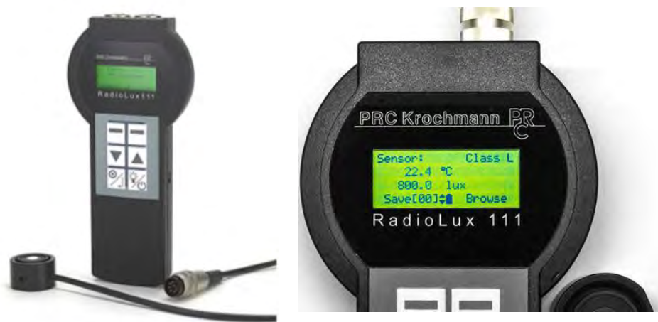
Afbeelding 4.4; Luxmeter Radiolux 111 fabrikant PRC Krochmann.
