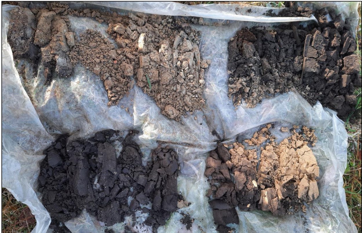
Figuur 7. Foto van boorprofiel 1 (0 – 200 centimeter). De leesrichting is van linksboven naar rechtsonder. (Foto: 22 december 2021)
