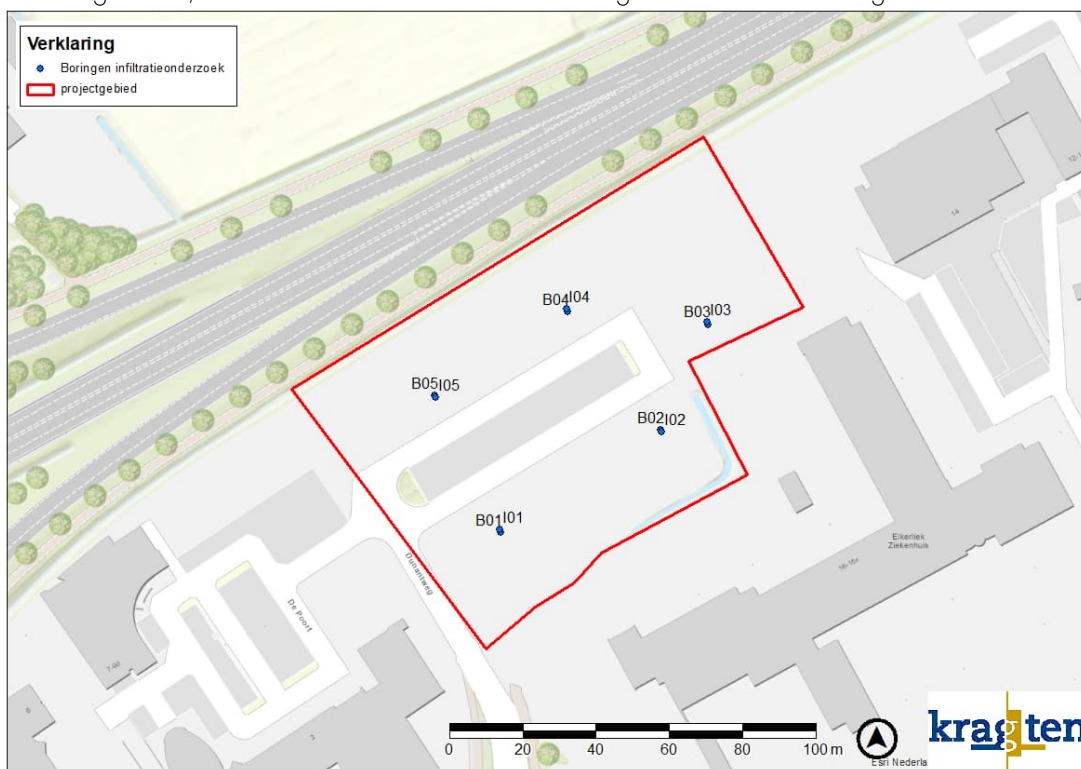
Figuur 7 locaties boringen en infiltratiemetingen
