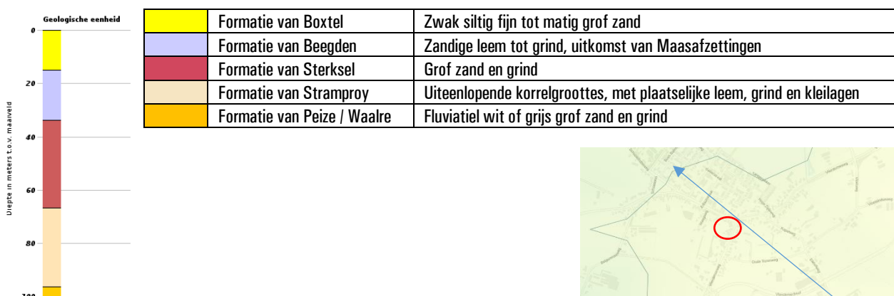
Figuur A: opbouw ondergrond.
