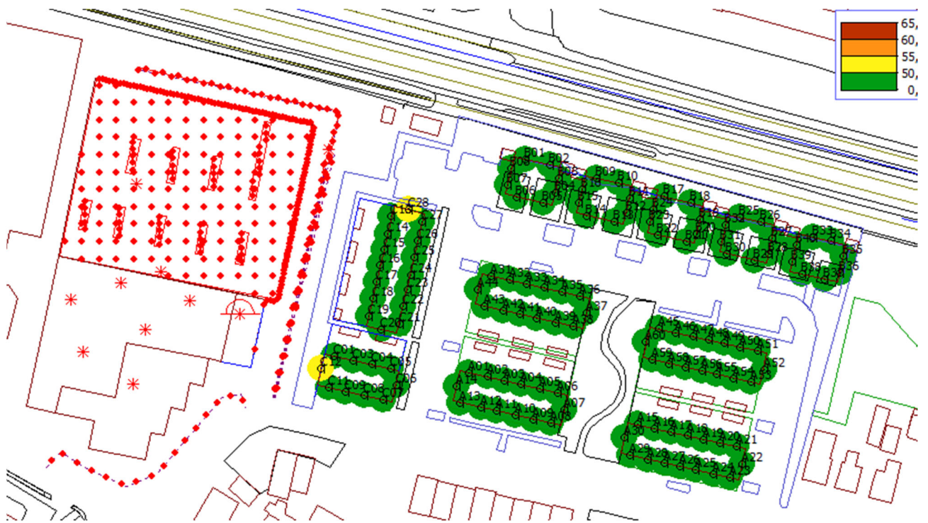
Figuur 6.1: Overzicht rekenresultaten na bronmaatregel bron 025 langtijdgemiddeld beoordelingsniveau (etmaalwaarde) 1,5 meter
