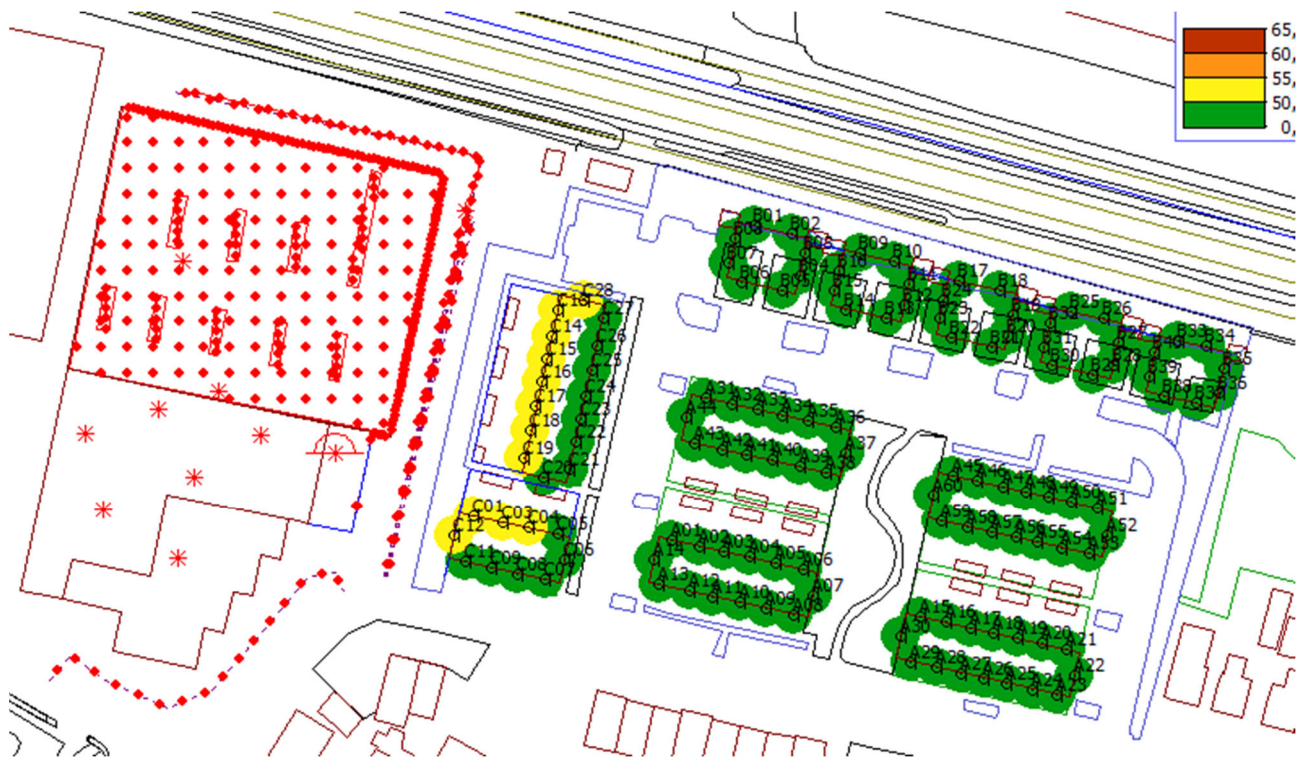
Figuur 6.2: Overzicht rekenresultaten na bronmaatregel bron 025 langtijdgemiddeld beoordelingsniveau (etmaalwaarde) 4,5 meter
