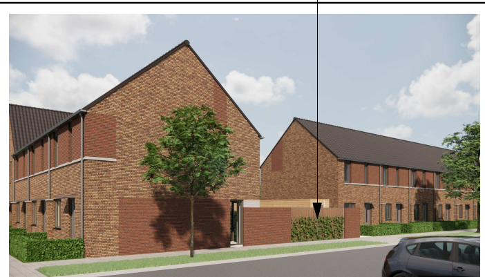
figuur 1, geluidscherm blok A, op as A.5 metselwerk en Kokowall-Lite geluidscherm
