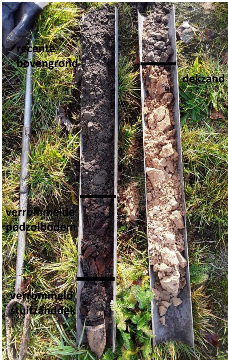
Figuur 7: Het opgeboorde sediment van boring 4 (bron: KSP Archeologie).
