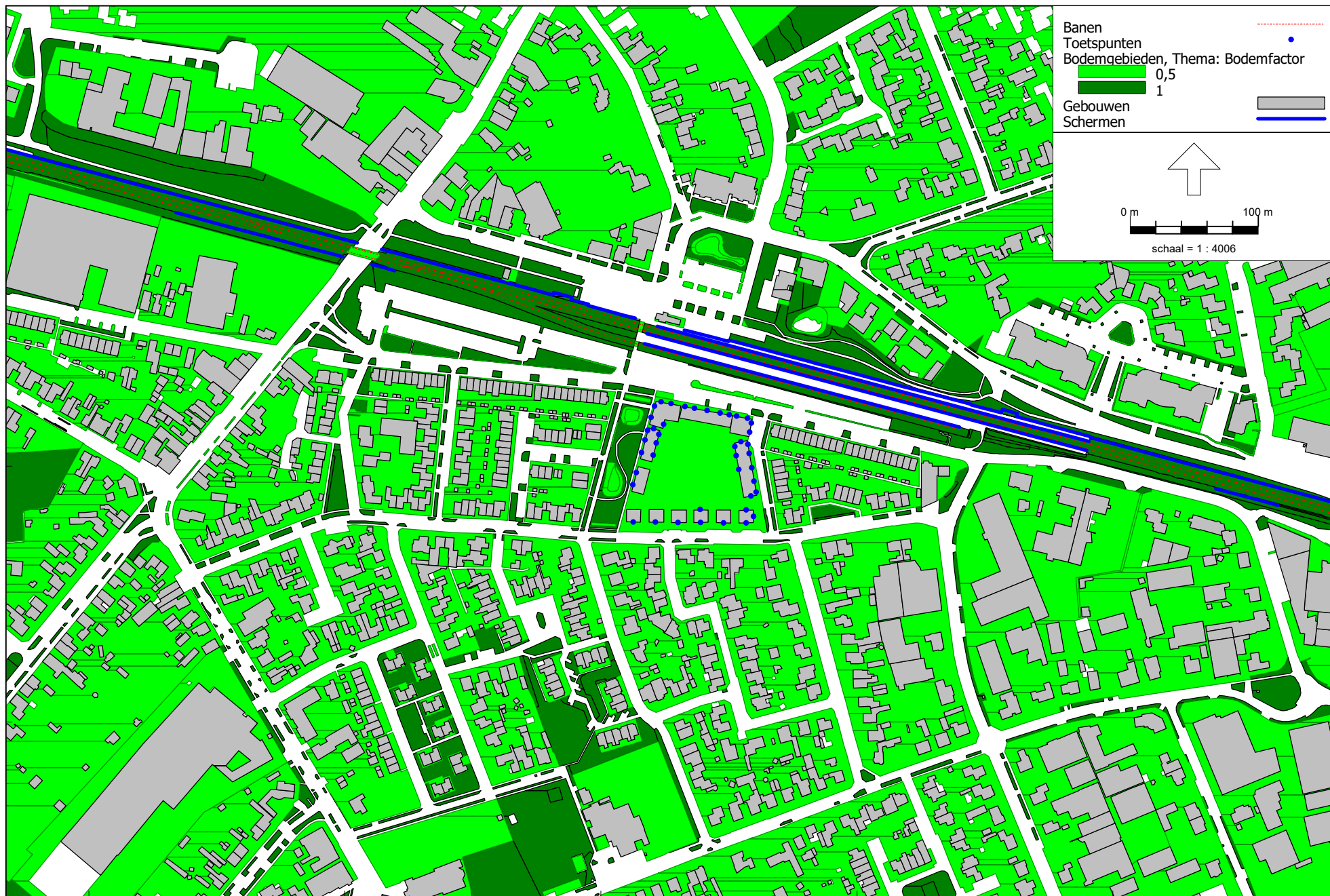
Figuur 4: Grafische rekenmodel rekenmodel bodemfactor
