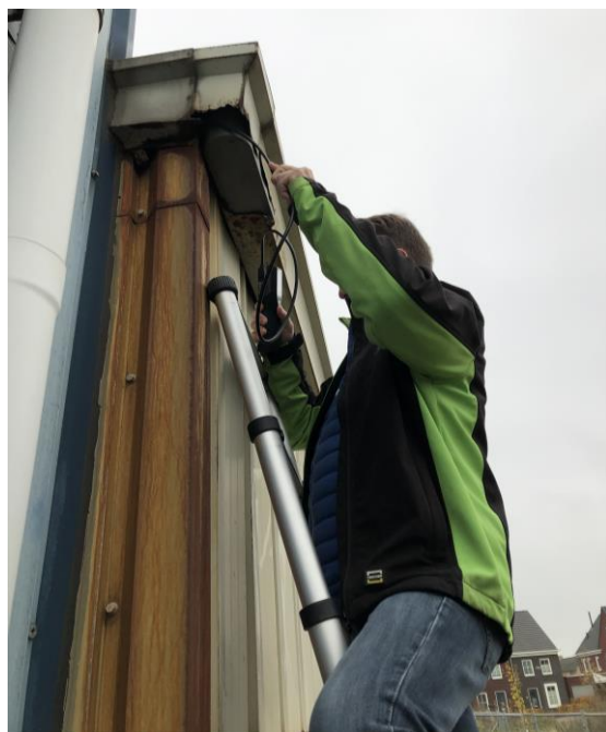
Figuur 22a en 22 b: Inwendige sonde inspectie van potentieel uitvlieggat. (vergelijk met figuren 12a en 12b).
