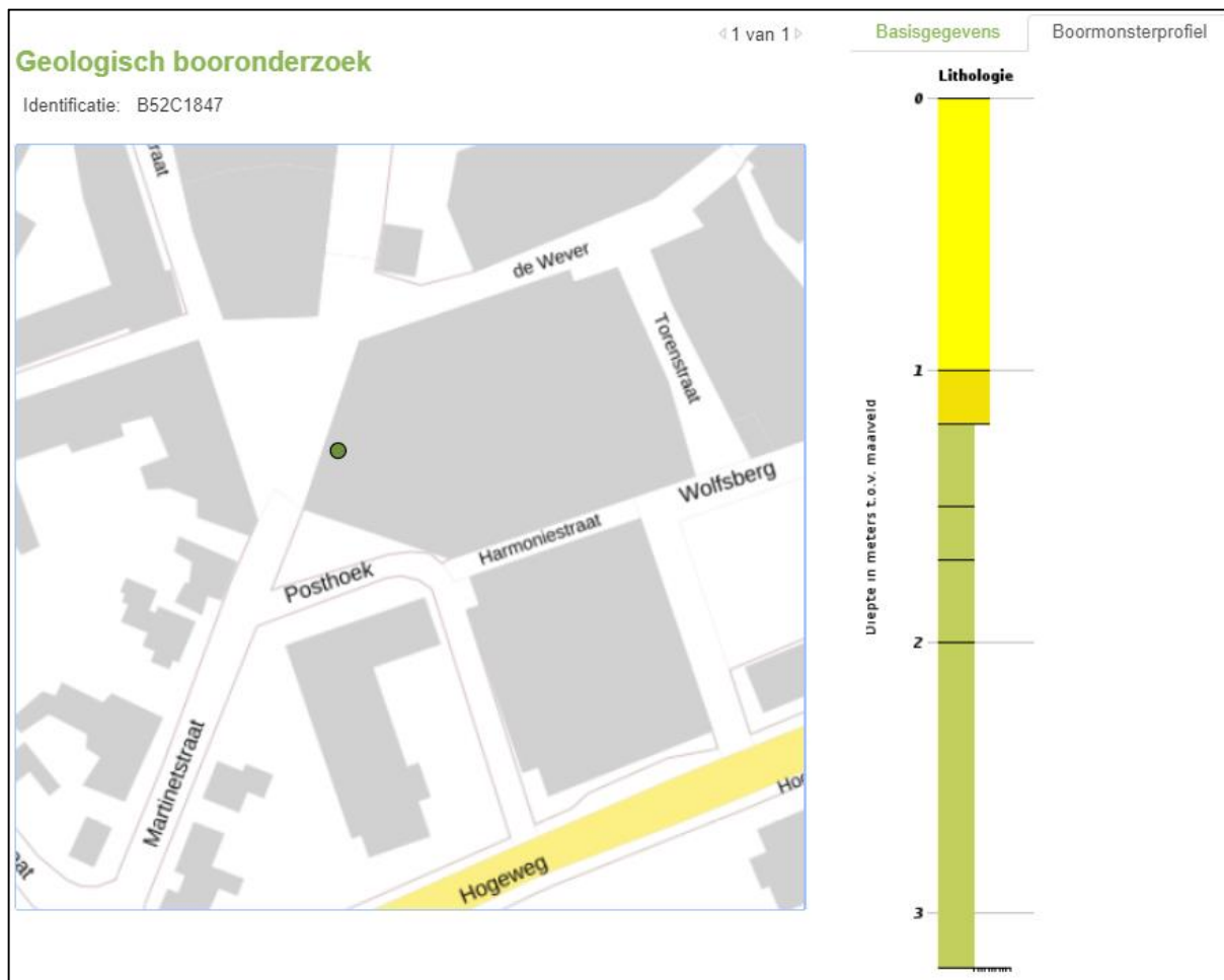
Figuur 2: Boormonsterprofiel B52C1847
