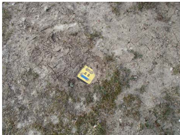
Foto 18. Peilbuis bestaand in puinpad langs spoor
