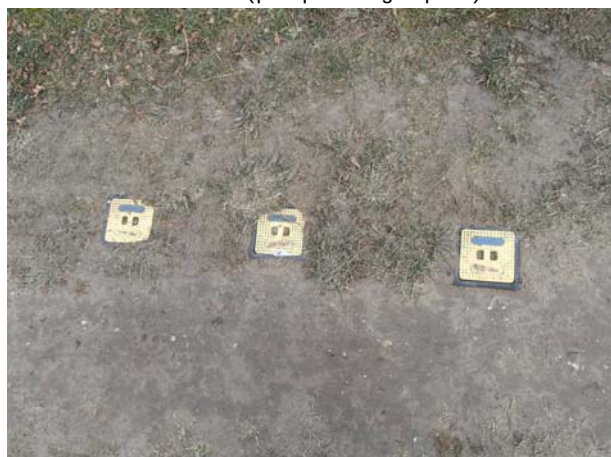
Foto 19. Peilbuizen bestaand in berm
