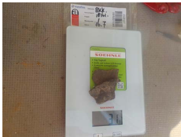
Foto 46. Asbesthoudend plaatmateriaal proefgat 16
