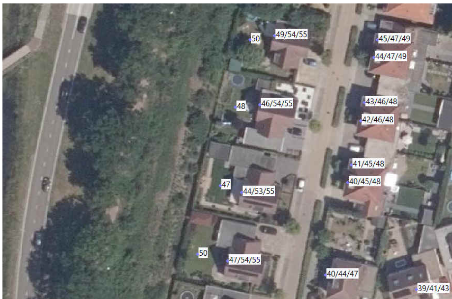
Figuur 5.2: Geluidsbelasting t.g.v. Binderendreef t.h.v. grondwal
