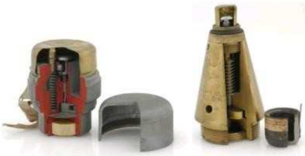
Figuur 8: Voorbeelden schokontstekers
