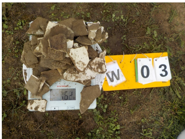
Foto 7: Vondst asbest plaatmateriaal in proefsleuf 03
