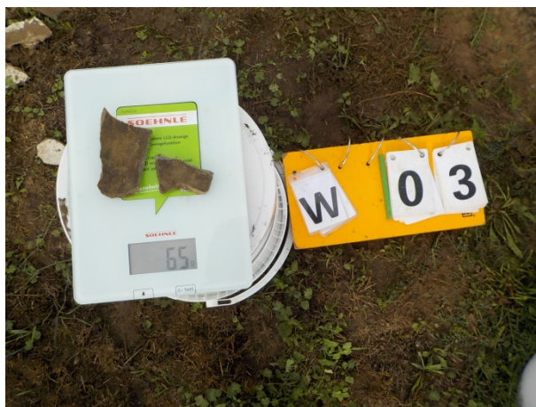
Foto 6: asbest golfplaat in proefsleuf 03
