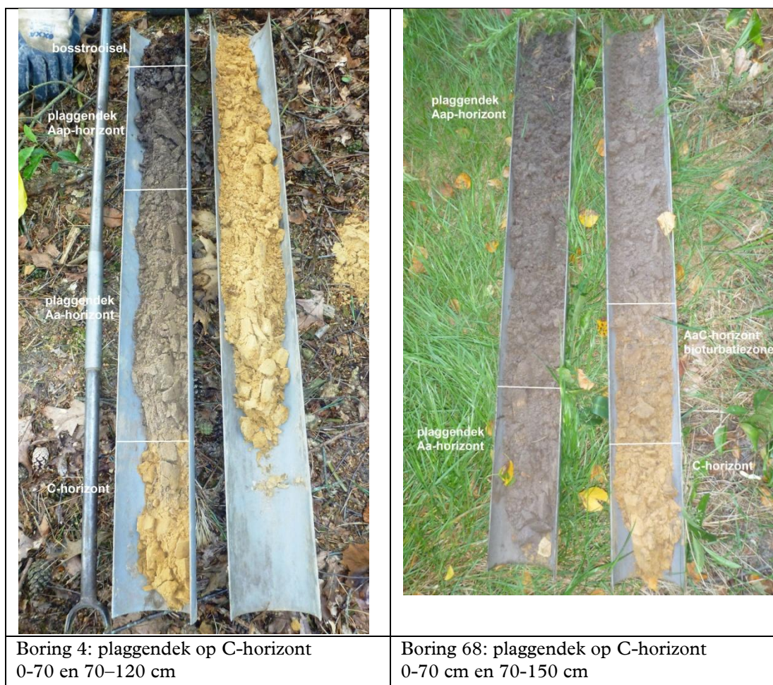
Fig. 3.6: Fotos van de aangetroffen enkeerdgronden (boring 4 en 68).
