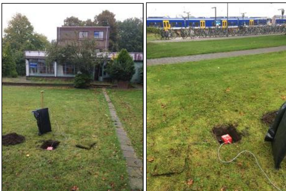
Figuur 3.1: Meetpositie trillingssensor
