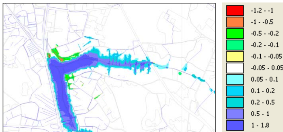
Figuur 6.8. Hoogteverschillen in de grondwaterstand, het basisalternatief in vergelijking met het nulalternatief. Duur waterberging: vijf dagen. De regenafvoer buiten de kades wordt met pompen geregeld.
