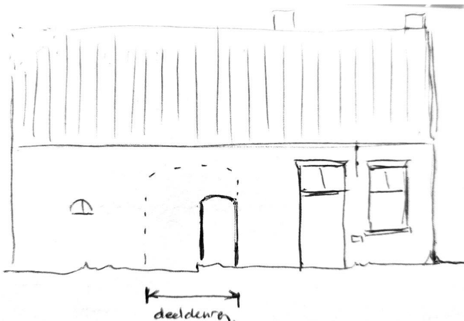
Schetsje van de voorgevel van Emerweg 55. Sporen in het interieur wijzen op aanwezigheid van deeldeuren in het verleden.
