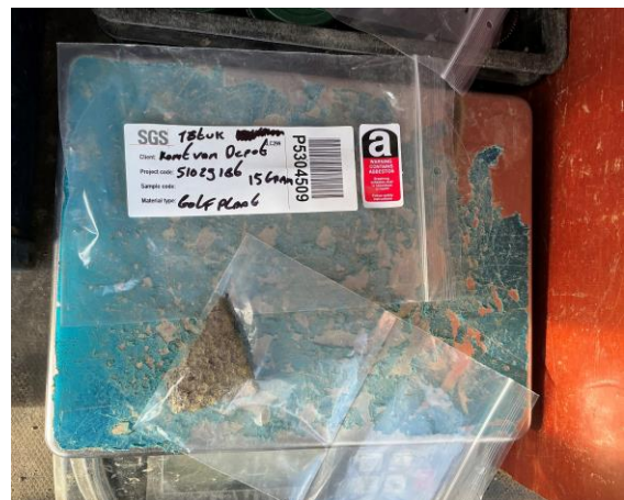
Foto 16. Asbestverdacht materiaal depot
