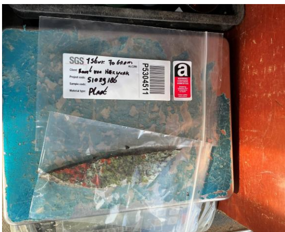
Foto 17. Asbestverdacht materiaal hek
