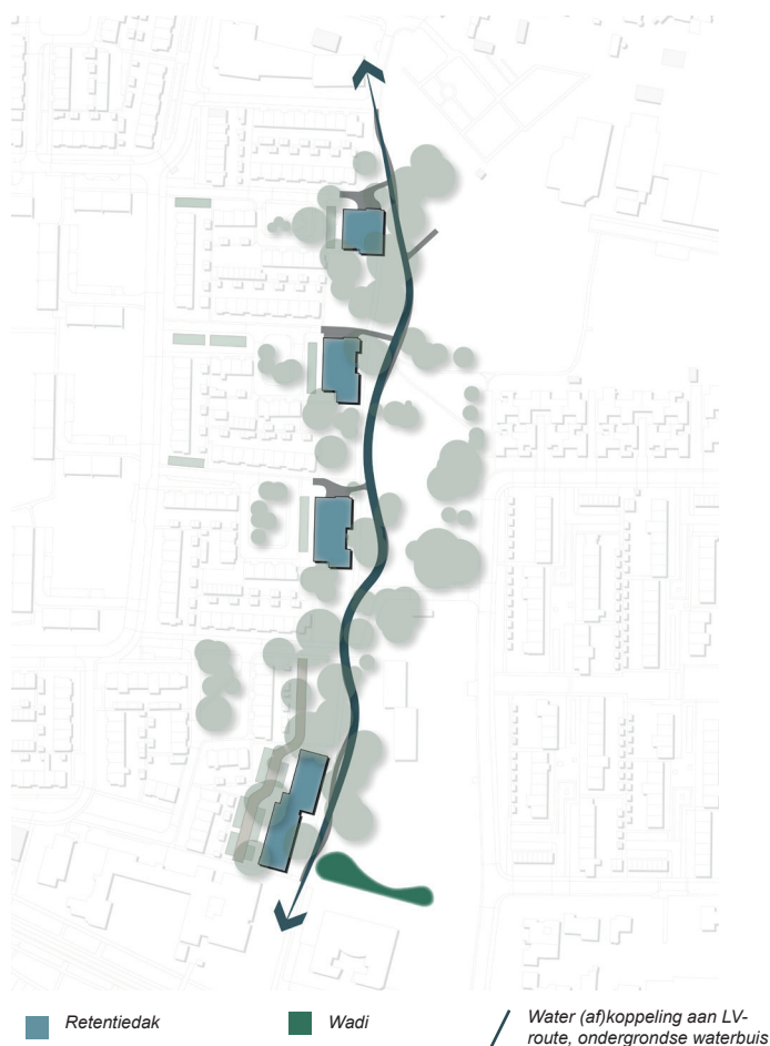
Principe water verbonden aan LV route en gebouwen, aansluitend op wadi Bron: Studio REDD
