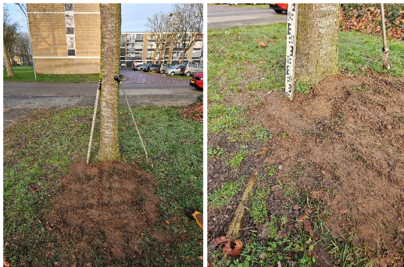
Afbeelding 9: Groeiplaatsonderzoek 4 links overzichtsfoto profielsleuf en rechts oppervlakkige stabiliteitswortel.
