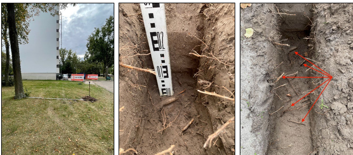
Afbeelding 6: Groeiplaatsonderzoek 2 links overzichtsfoto profielsleuf, midden aanzicht diepte profielsleuf en rechts inkijk profielsleuf met aangegeven opname- en stabiliteitswortels (rode pijlen).
