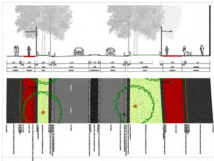
Figuur 57. Profiel Stationslaan ter plaatse van Faamplein
