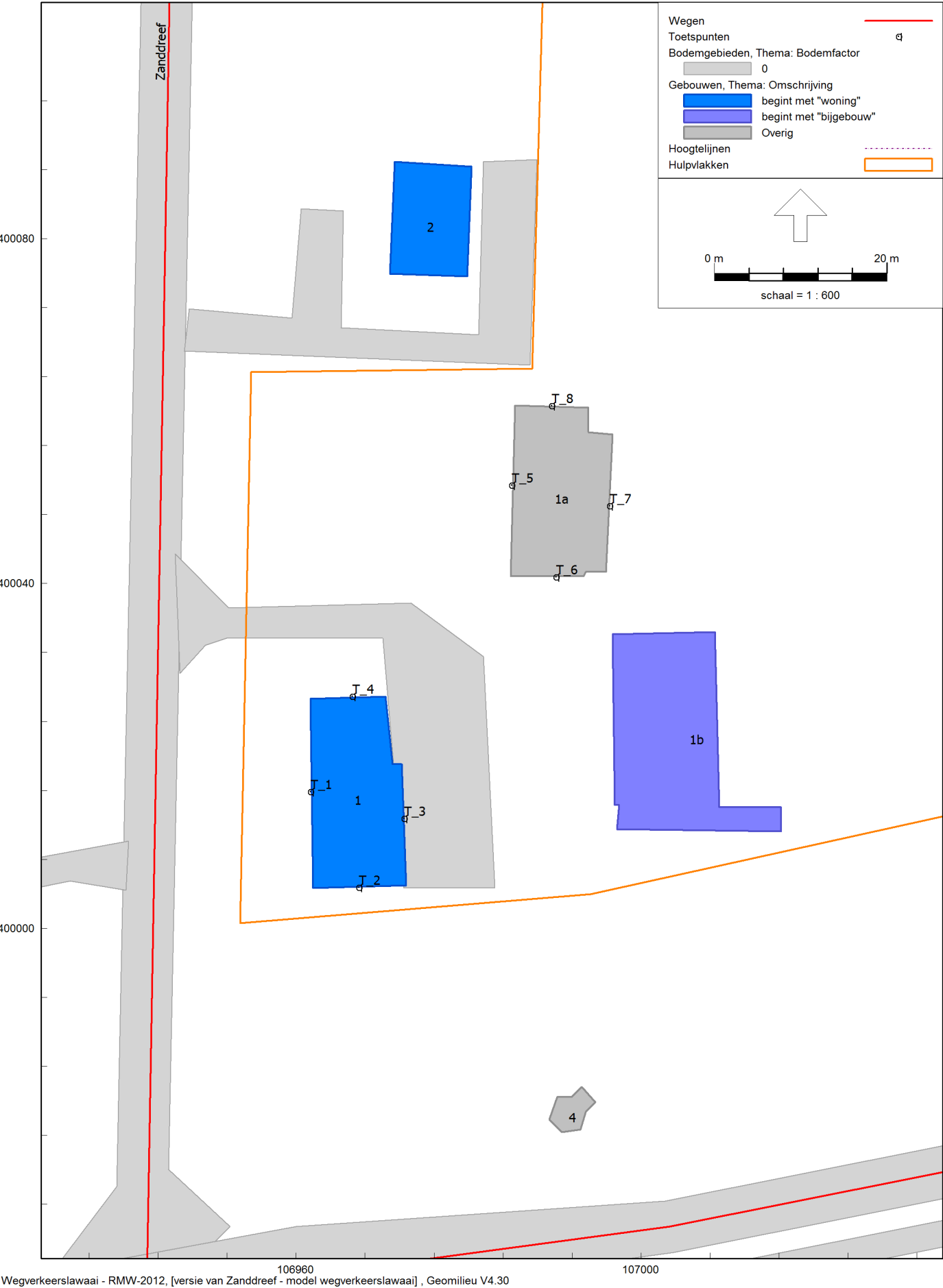
Detailweergave model wegverkeerslawaaï met inzoom op toetspunten
