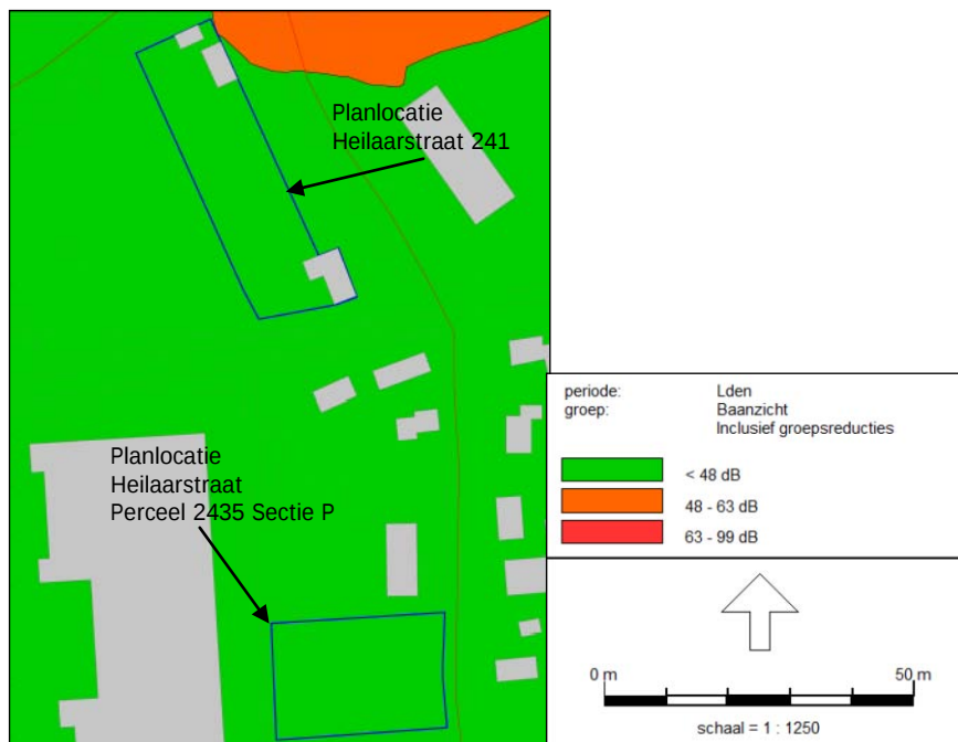
Figuur 3.6: Contouren als gevolg van de Baanzicht, incl. aftrek artikel 110g Wgh voor het jaar 2021, waarneemhoogte 7,5 m
