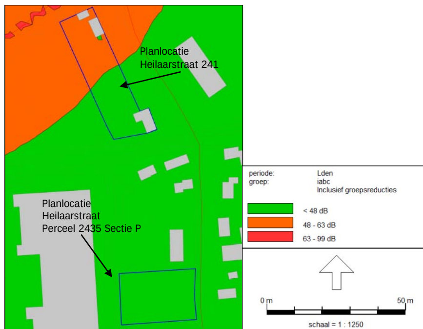
Figuur 3.9: Contouren als gevolg van de IABC, incl. aftrek artikel 110g Wgh voor het jaar 2021. Waarneemhoogte 7,5 m
