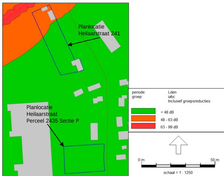
Figuur 3.7: Contouren als gevolg van de IABC, incl. aftrek artikel 110g Wgh voor het jaar 2021. Waarneemhoogte 1,5 m
