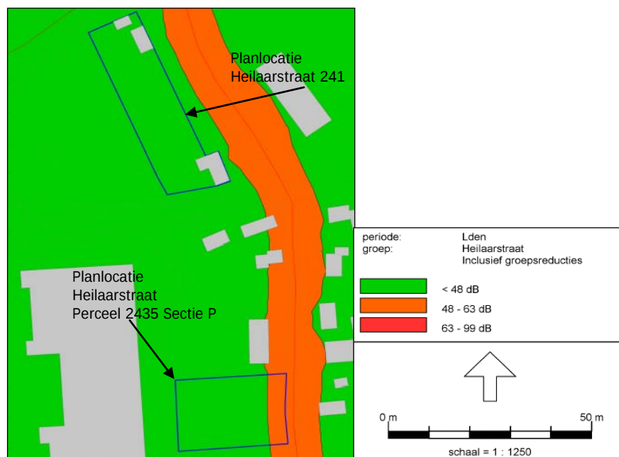
Figuur 3.2: Contouren als gevolg van de Heilaarstraat incl. aftrek artikel 110g Wgh voor het jaar 2021. Waarneemhoogte 4,5 m
