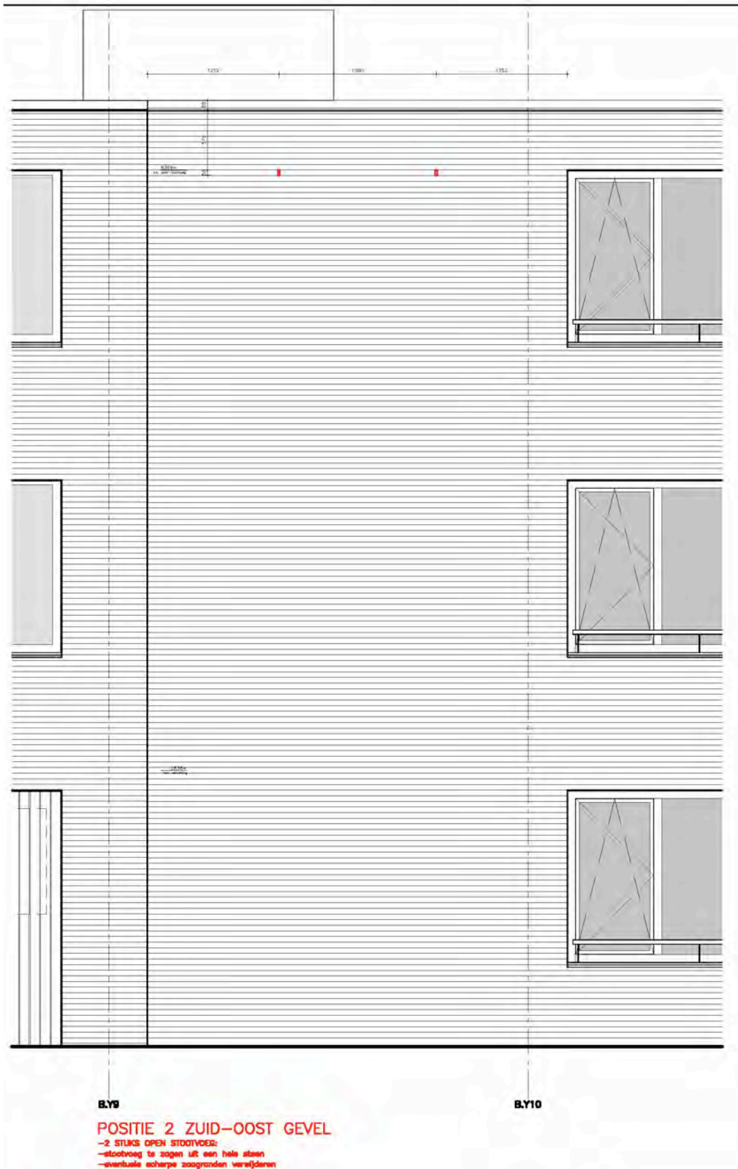
Afbeelding 6: Detail van de aan te brengen open stootvoegen op één van de gevels van Bouwdeel B
