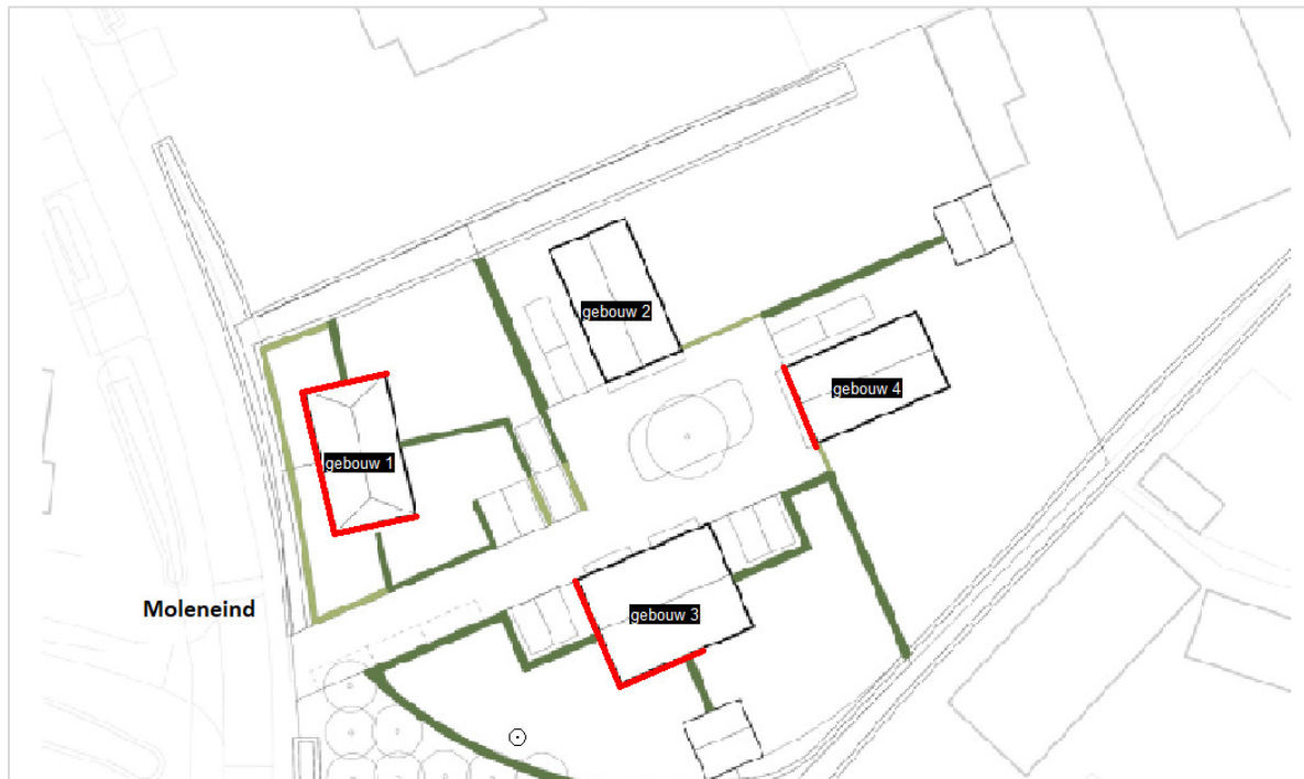
Figuur 4.1 Gevels met overschrijdingen (rode belijning).
