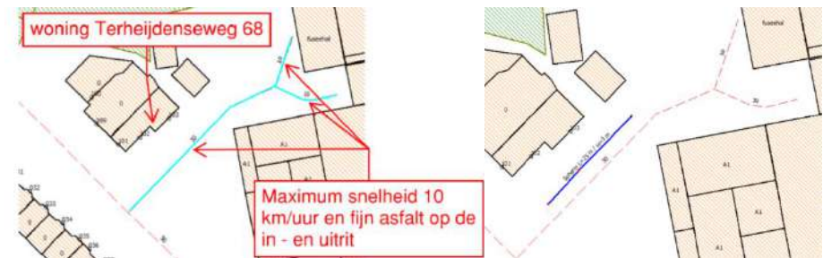
Figuur 5.4 – Maatregel 10 km/uur + fijn asfalt
