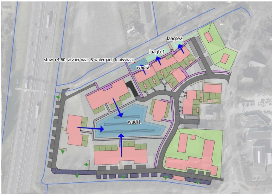
Figuur 3.5 Schematische weergave watersysteem
