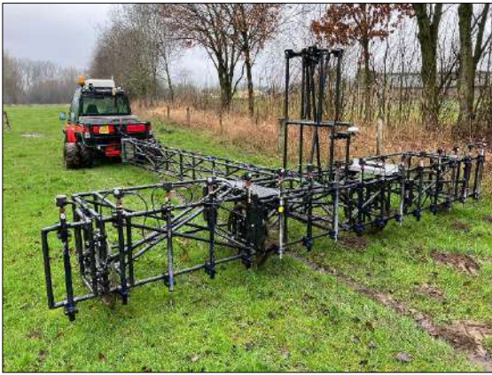
Figuur 3. Passieve non realtime oppervlakedetectie met het Vallon Multisondesysteem VXV16 en een staafdiagram waarop het maximale detectiebereik ( m^2 - maaiveld) per kaliber.
