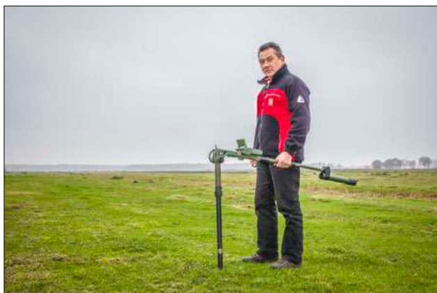
Figuur 7. Passieve realtime oppervlakedetectie met een Vallon VX1 Magnetometer en een staafdiagram waarop het maximale detectiebereik ( m^3 - maaiveld) per kaliber.
