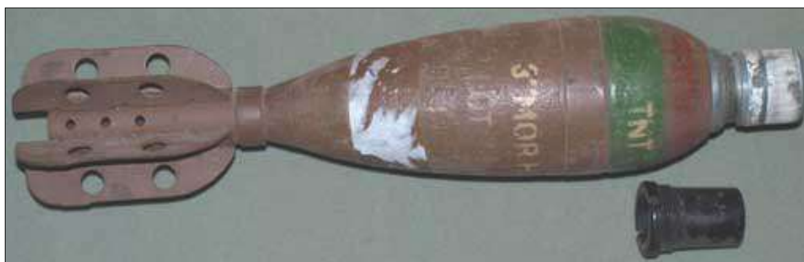
Geallieerde mortiergranaat van 3 inch
