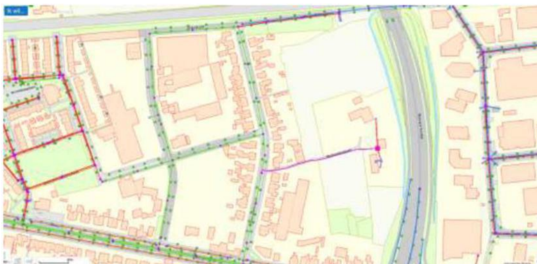
Figuur 2-7: Rioolsysteem in en om plangebied, met gemengd stelsel in groen, hemelwaterstelsel in blauw, vuilwater in rood en drukriolering in paars.
