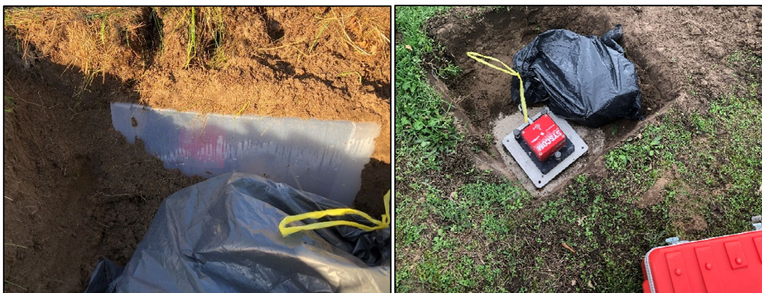
Figuur 3.2: De trillingssensor ingegraven bij meetpunt 1 links en bij meetpunt 3 rechts in beeld.
