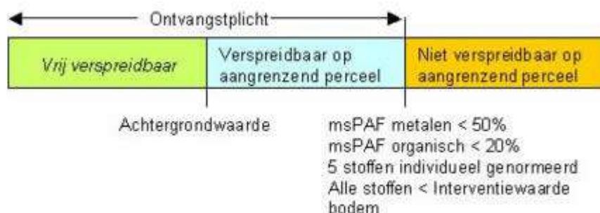
Figuur 4.2. Schematische weergave verspreiden baggerspecie op aangrenzende percelen
