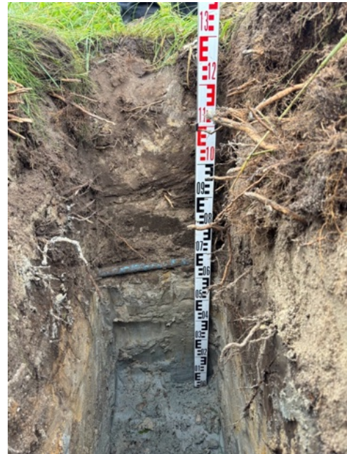
Afbeelding 10 en 11) Onder de bestrating zijn geen wortels aangetroffen. Kabel in mantel zoals aangegeven op de Klic. Profiel kuil #1.
