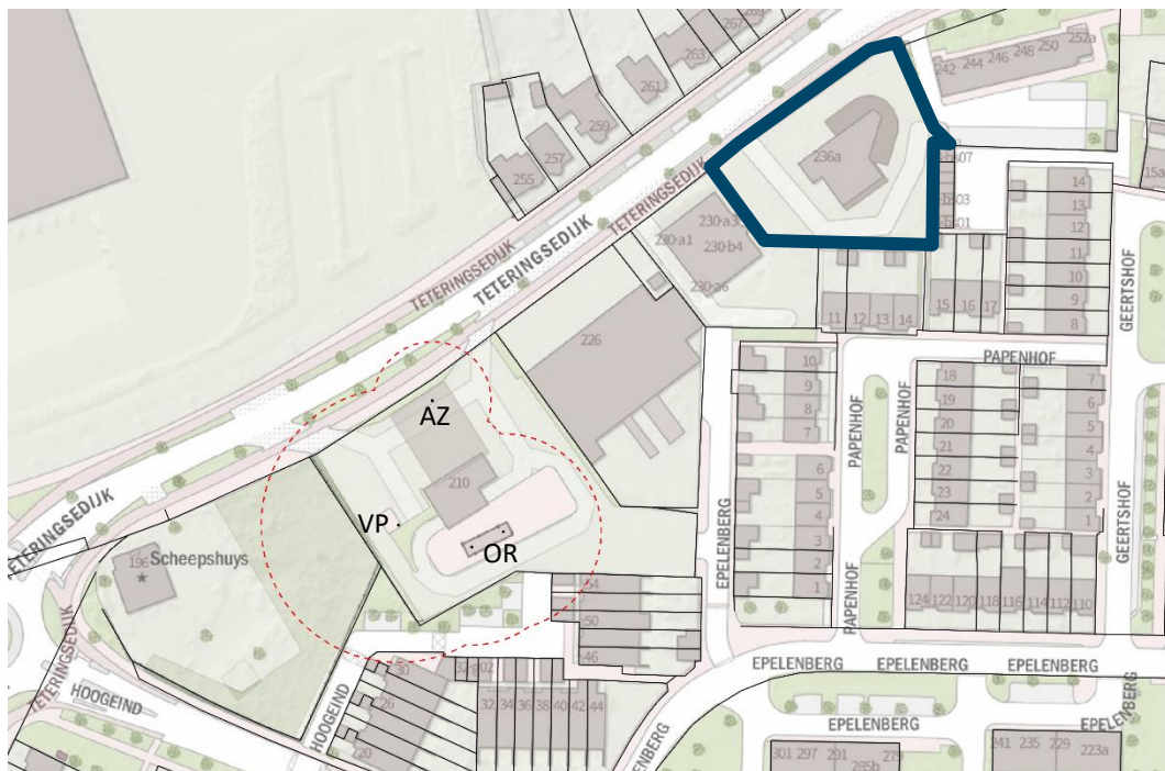
Figuur 3.1: Weergave risicopunten LPG-tankstation (zwarte punten: LPG-vulpunt (VP), Ondergronds reservoir (OR) en afleverzuil (AZ)) en bijbehorende PR 10 -6 -contouren (rode stippellijn) ten opzichte van het plangebied (blauw).
