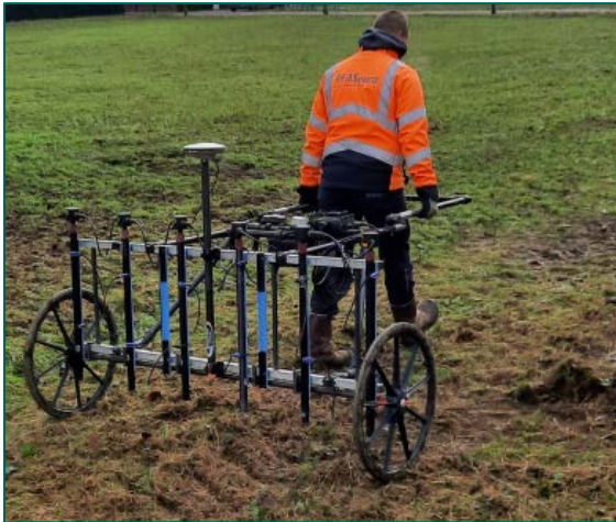
Figuur 4: Operator met multisonde detectiesysteem.
