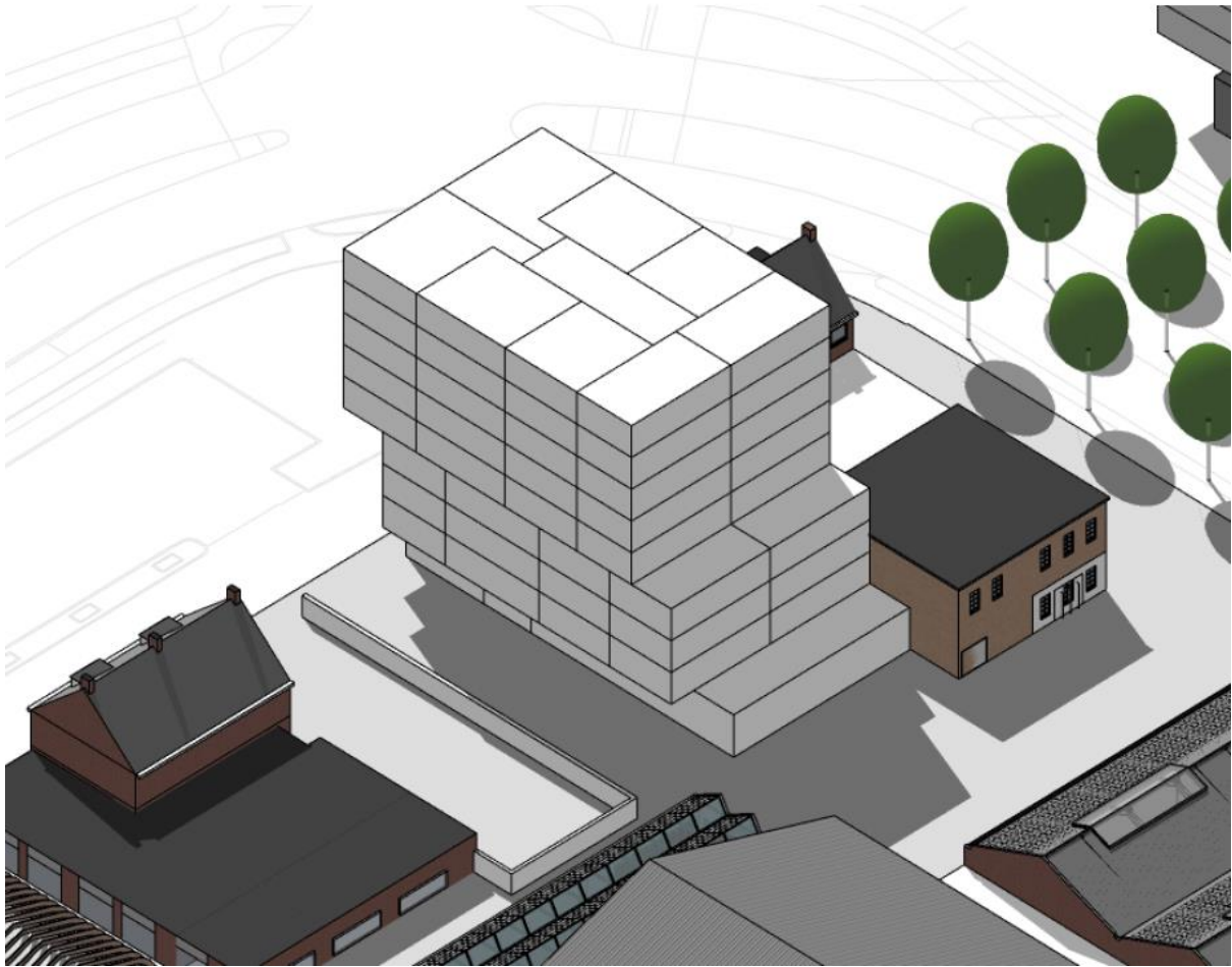
Figuur 11: In- en uitspringende gevels op de onderste etages.
