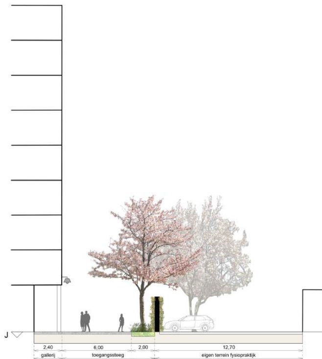
Figuur 15: Doorsnede appartement gebouw door de toegangssteeg.
