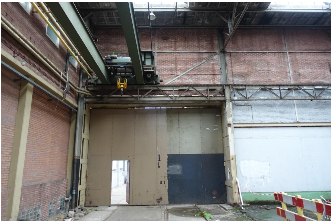
De rolkraan in de westelijke hal, deze overspant de hal middels twee zware stalen liggers.
