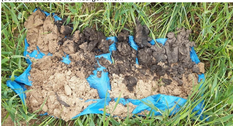
Afbeelding 4. Boring 1 zo goed mogelijk uitgelegd tussen de begroeiing; linksonder maaiveld, rechtsboven 2 m-mv. (foto: Antea Group).
